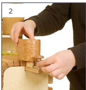
2. Bringen Sie den Abdunktionskeil in die korrekte Stellung, indem Sie den Hebel lockern und den Keil nach vorne schieben. Anschließend die Schraube und Beilagscheibe handfest anziehen, um so den Keil erneut zu fixieren.
