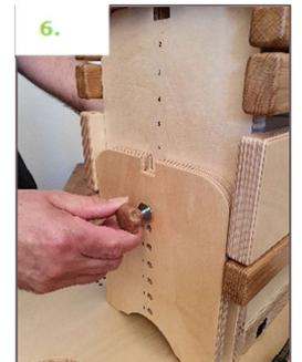
6. Neben den Einstellhöhen sind **Ziffern**. Diese helfen bei der korrekten Einstellung und müssen **vorne** und **hinten** identisch sein.
